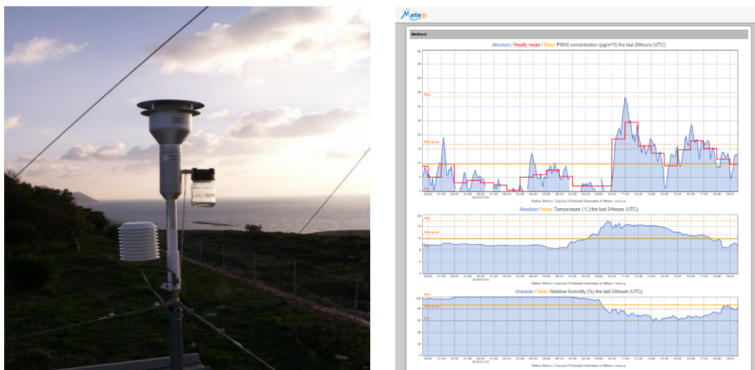
Εικόνα 19: (α) Η εξωτερική διάταξη του εγκατεστημένου σταθμού της Μεθώνης όπου διακρίνονται η κεφαλή με το δοχείο αποβολής ξένων σωμάτων (πχ. νερό) και η ασπίδα (shield) ηλιακής 38
