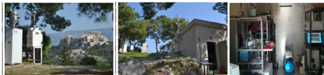
Εικόνα 16: Αστικός Σταθμός Παρακολούθησης Ατμοσφαιρικής Ρύπανσης στο Θησείο: Δειγματολήπτες αιωρούμενων σωματιδίων χαμηλού και υψηλού όγκου (αριστερά), εξωτερικός (μέση) και εσωτερικός χώρος με μετρητικά συστήματα (δεξιά).
