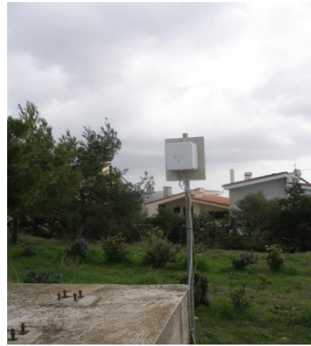
Εικόνα 32: (α) Γεωγραφική κατανομή των αισθητήρων του συστήματος ZEUS, (β) Η εξωτερική μονάδα ανίχνευσης των ηλεκτρικών εκκενώσεων.
