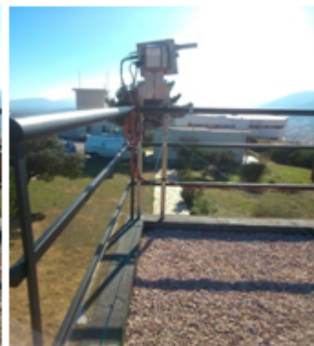
Εικόνα 3: (α) Το σύστημα MAX-DOAS στις εγκαταστάσεις του ΕΑΑ στην Πεντέλη, (β) οι κύριες αζιμούθιες διευθύνσεις με διαφορετικά χαρακτηριστικά ρύπανσης.
