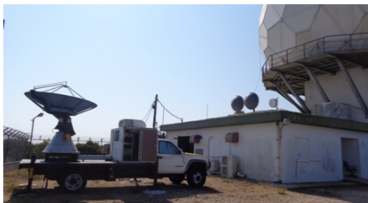
Εικόνα 21: Το κινητό ραντάρ του ΕΑΑ εγκατεστημένο δίπλα στο ραντάρ ελέγχου κυκλοφορίας της ΥΠΑ στην Κέρκυρα.
