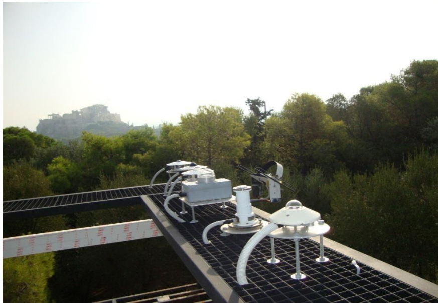
Εικόνα 35: Μερική άποψη του ΑΣΕΑΑ. Διακρίνονται τα όργανα μέτρησης ολικής ηλιακής ακτινοβολίας, ολικού φωτισμού, υπέρυθρης και υπεριώδους ακτινοβολίας.
