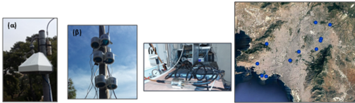
Εικόνα 18: Ολοκληρωμένα συστήματα μέτρησης ατμοσφαιρικής ρύπανσης (α) μέσω κόστους, (β) χαμηλού κόστους και (γ) μικρο-αιθαλόμετρα για την μέτρηση BC σε πολλαπλά μήκη κύματος, δ) χάρτης σημείων δικτύου αισθητήρων στο λεκανοπέδιο Αττικής.
