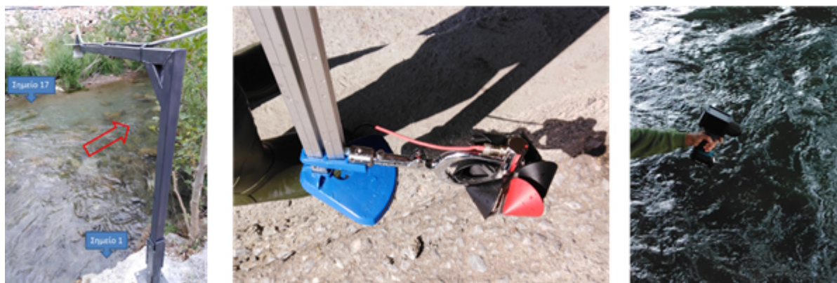
Εικόνα 29: Υδρο-τηλεμετρικός σταθμός Ευρώτα – Άνω ρους, χωριό Καραβάς. Άνω: Διατομή και σημεία υδρομετρήσεων με μιλίσκο. Κάτω: Ορισμός της διατομής υδρομέτρησης (αριστερά), μιλίσκος (κέντρο), υδρομέτρηση με SVR (δεξιά).
