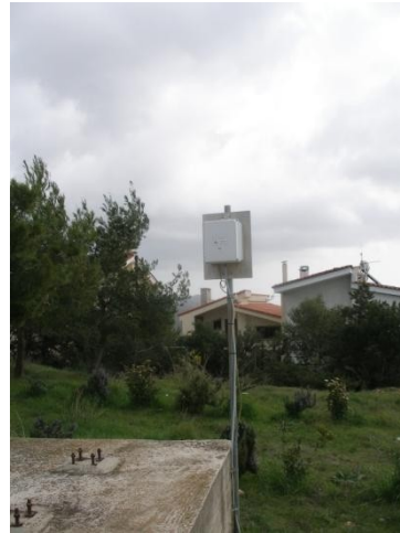
Εικόνα 22: (α) Γεωγραφική κατανομή των αισθητήρων του συστήματος ZEUS, (β) Η εξωτερική μονάδα ανίχνευσης των ηλεκτρικών εκκενώσεων.
