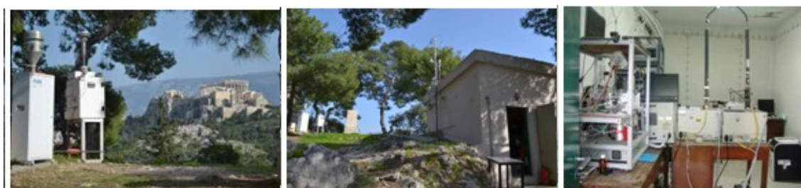
Εικόνα 11: Αστικός Σταθμός Παρακολούθησης Ατμοσφαιρικής Ρύπανσης στο Θησείο: (αριστερά) Δειγματολήπτες αιωρούμενων σωματιδίων χαμηλού και υψηλού όγκου, εξωτερικός (μέση) και (δεξιά) εσωτερικός χώρος με μετρητικά συστήματα.
