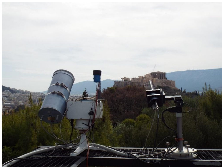
Εικόνα 27: Ο εξοπλισμός φασματικής καταγραφής της ηλιακής ακτινοβολίας - PSR και PANDORA- εν λειτουργία φασματοφωτομετρική ακτινομετρική πλατφόρμα του ΙΕΠΒΑ/ΕΑΑ στο Θησείο.
