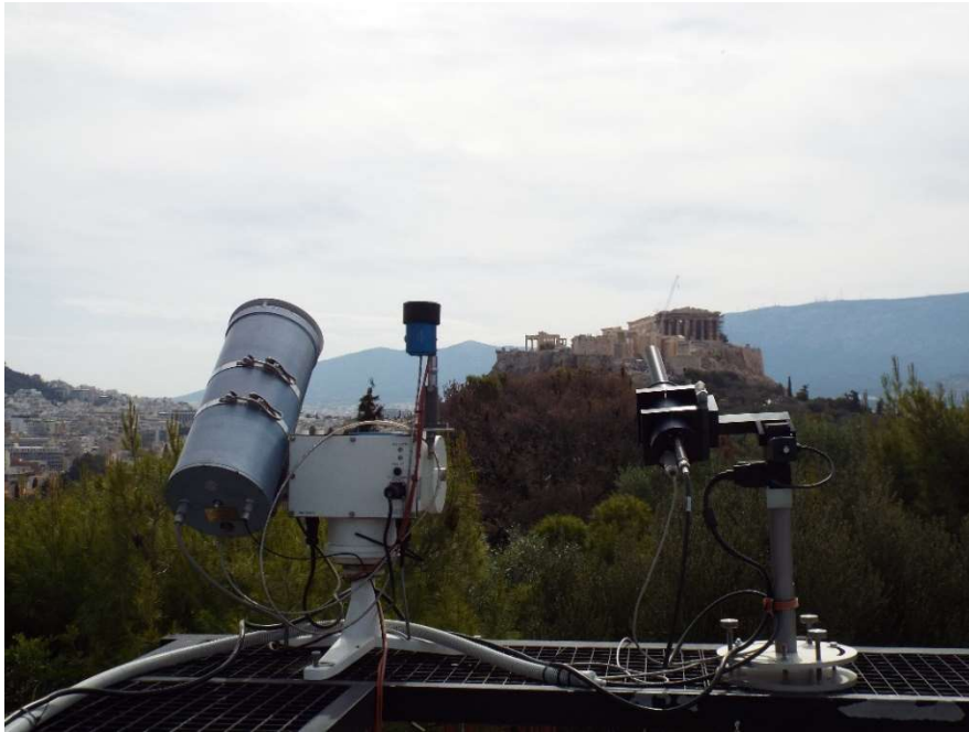
Εικόνα 23. Ο εξοπλισμός φασματικής καταγραφής της ηλιακής ακτινοβολίας – PSR και PANDORA- εν λειτουργία στον ακτινομετρικό σταθμό του ΙΕΠΒΑ/ΕΑΑ στο Θησείο.
