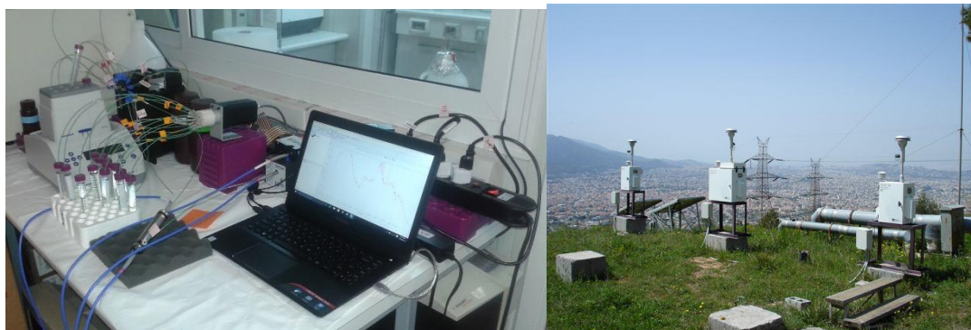
Εικόνα 3-1. (α) Ημιαυτοματοποιημένο αναλυτικό σύστημα για τον προσδιορισμό των δραστικών οξειδωτικών ενώσεων, (β) Δειγματολήπτες αιωρούμενων σωματιδίων ΑΣ10 και ΑΣ2.5 στην Πεντέλη..
