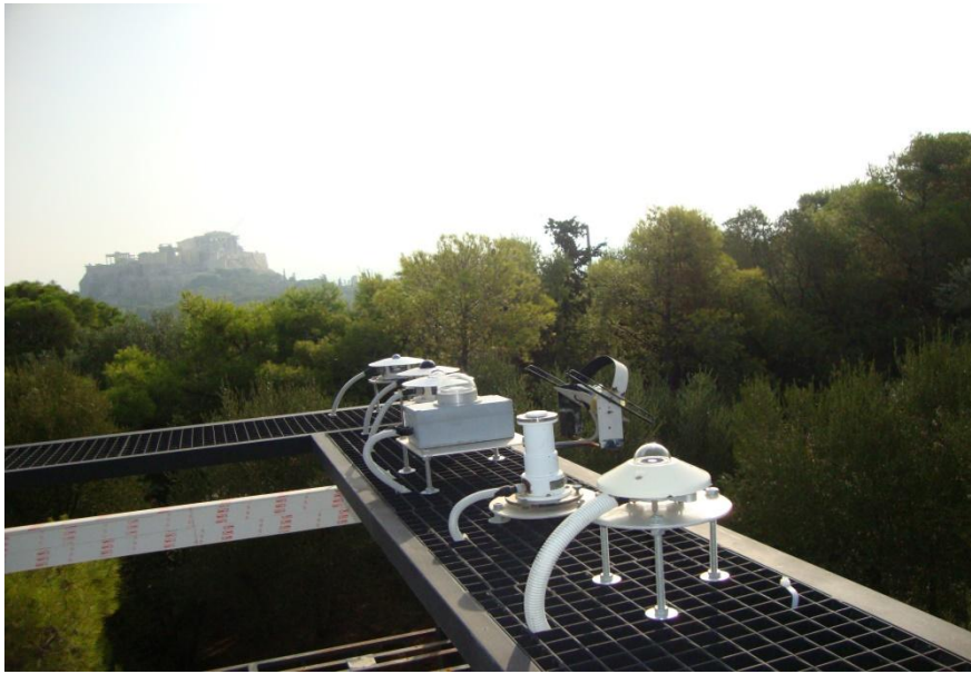
Εικόνα 3-8. Μερική άποψη του ΑΣΕΑΑ. Διακρίνονται τα όργανα μέτρησης ολικής ηλιακής ακτινοβολίας, ολικού φωτισμού, υπέρυθρης και υπεριώδους ακτινοβολίας.
