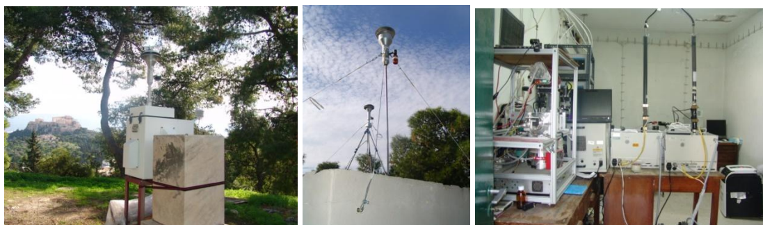
Εικόνα 3-2. Αστικός Σταθμός Παρακολούθησης Ατμοσφαιρικής Ρύπανσης στο Θησείο: (αριστερά) Δειγματολήπτης αιωρούμενων σωματιδίων \text{AS}_{10} και \text{AS}_{2.5} , (μέση) Γραμμές δειγματοληψίας αέριων και σωματιδιακών ρύπων στην ταράτσα του κυρίως κτιρίου, (δεξιά) εσωτερικός χώρος και μετρητικά συστήματα.
