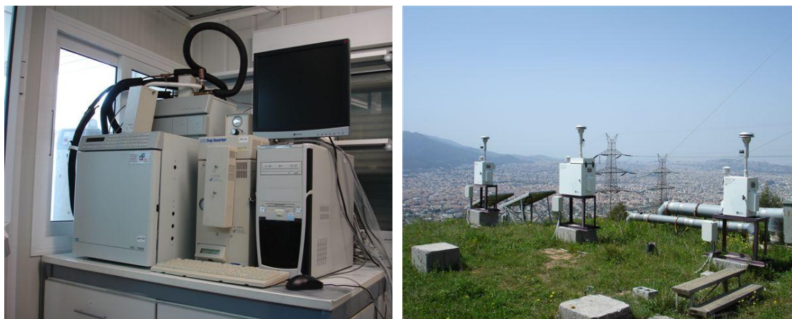
Εικόνα 3-1. (α) Αέριος χρωματογράφος με ανιχνευτή ιονισμού φλόγας, (β) Δειγματολήπτες αιωρούμενων σωματιδίων ΑΣ 10 και ΑΣ 2,5 στην Πεντέλη.
