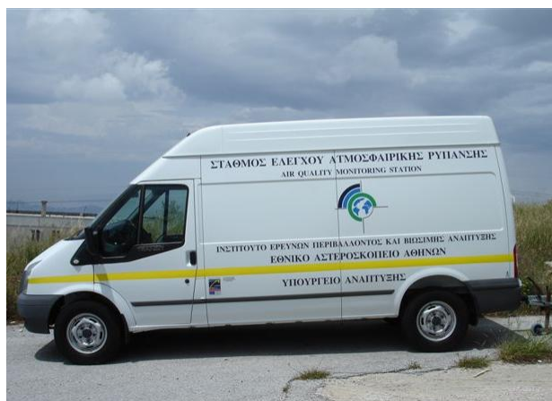
Εικόνα 3-3. Κινητός Σταθμός Ελέγχου Ατμοσφαιρικής Ρύπανσης και Θορύβου.
