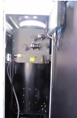
Τηλεσκόπιο και οπτική διάταξη εκπομπής laser ακτινοβολίας στο υπεριώδες, ορατό και υπέρυθρο
