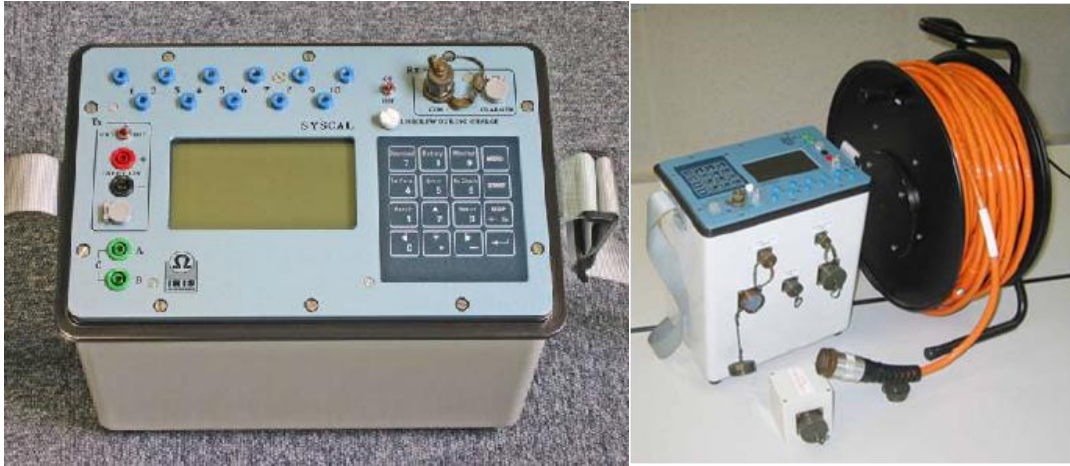
Εικόνα 4.1.9-4. Ο εξοπλισμός γεωηλεκτρικής τομογραφίας του Γ.Ι.
