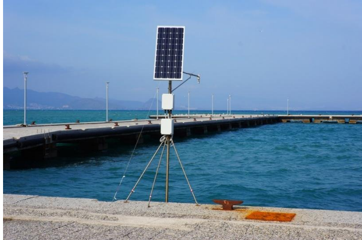
Εικόνα 4.1.5-3. Ο νέος παλιρροιογράφος που εγκαταστάθηκε στην Κω τον Ιούλιο του 2018.
