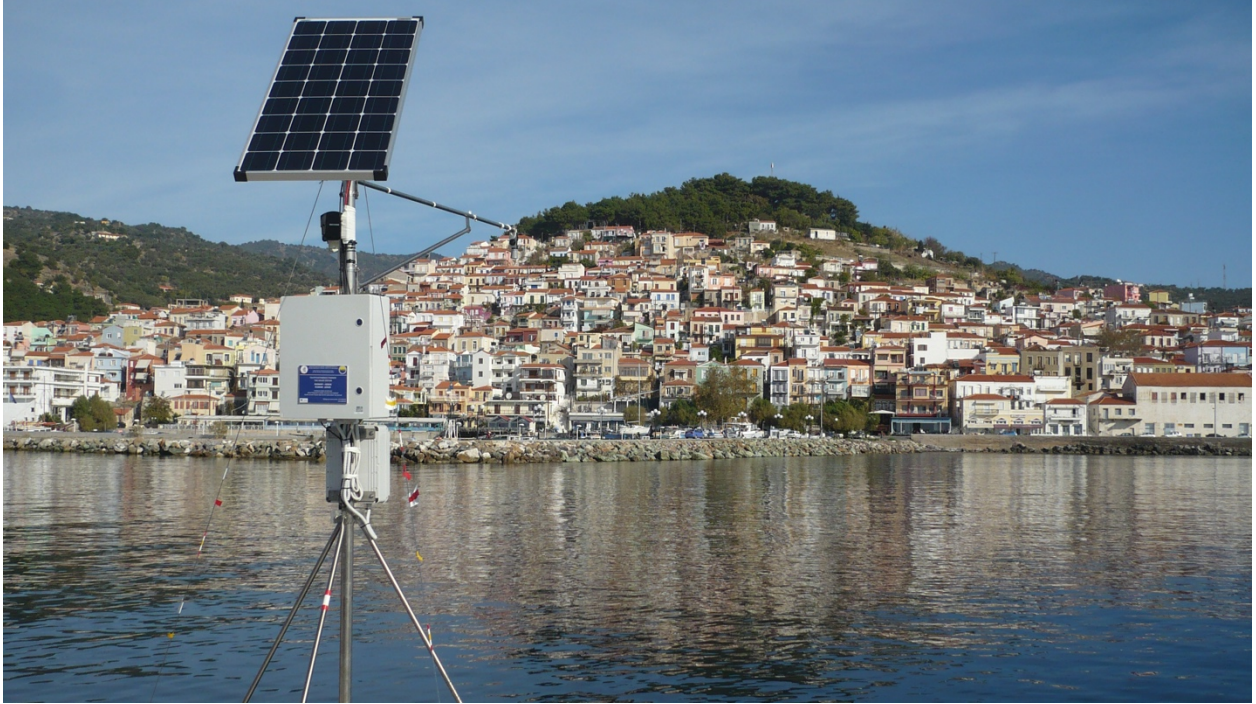
Εικόνα 4.1.5-3. Ο νέος παλιρροιογράφος που εγκαταστάθηκε στο Πλωμάρι το Νοέμβριο του 2019.
