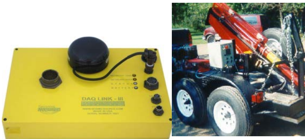
Εικόνα 4.1.9-2. Πολυκαναλικός Σειсмоγράφος και η πηγή του επιταχυνόμενου πίπτοντος βάρους.
