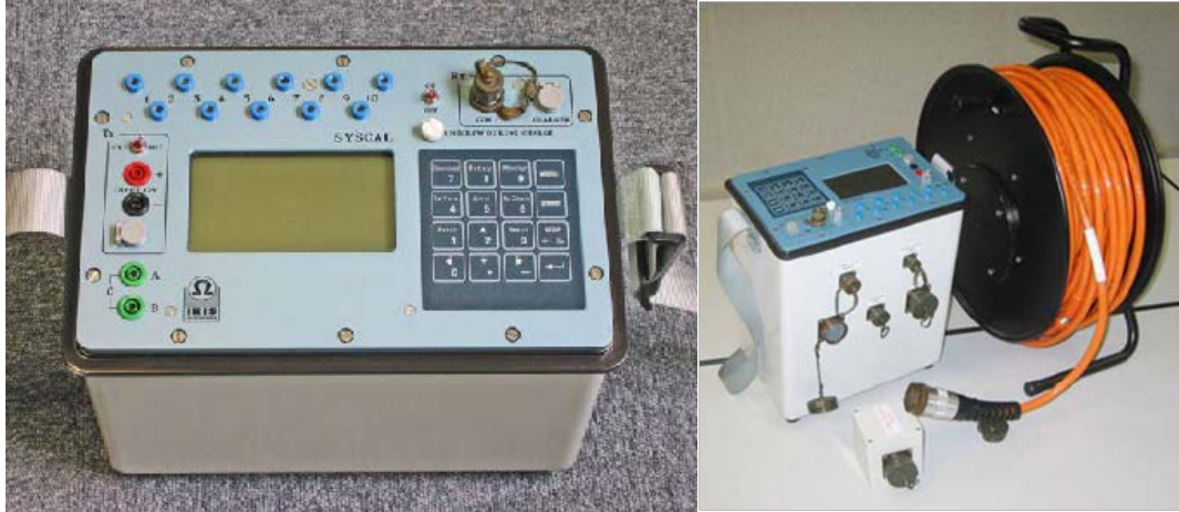
Εικόνα 4.1.9-4. Ο εξοπλισμός γεωηλεκτρικής τομογραφίας του Γ.Ι.
