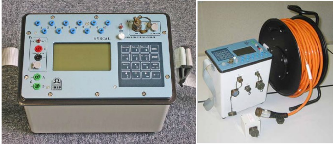
Εικόνα 4.1.9-4. Ο εξοπλισμός γεωηλεκτρικής τομογραφίας του Γ.Ι.
