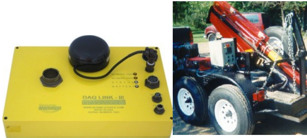
Εικόνα 4.1.9-2. Πολυκαναλικός Σεισμογράφος και η πηγή του επιταχυνόμενου πίπτοντος βάρους.
