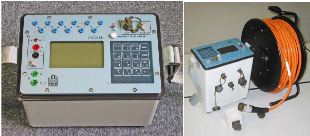
Εικόνα 3.2.8-4. Ο εξοπλισμός γεωηλεκτρικής τομογραφίας του Γ.Ι.
