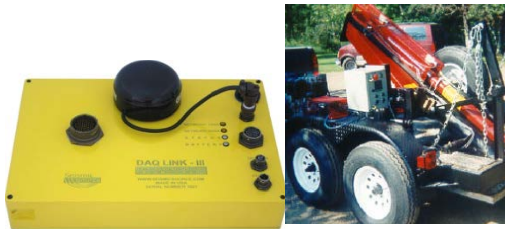
Εικόνα 3.2.8-2. Πολυκαναλικός Σειсмоγράφος και η πηγή του επιταχυνόμενου πίπτοντος βάρους.
