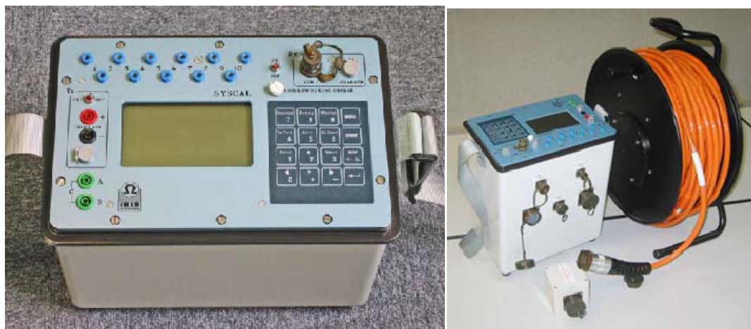
Εικόνα 3-19. Ο εξοπλισμός γεωηλεκτρικής τομογραφίας του Γ.Ι.
