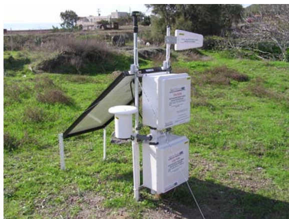
Εικόνα 3-24. Μαγνητομετρικός σταθμός στη Σαντορίνη.
