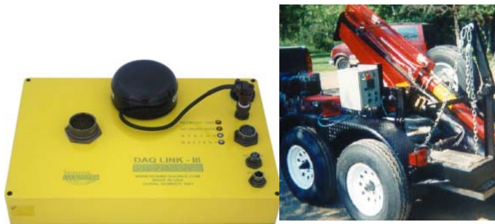
Εικόνα 3-17. Πολυκαναλικός Σεισμογράφος και η πηγή του επιταχυνόμενου πίπτοντος βάρους.
