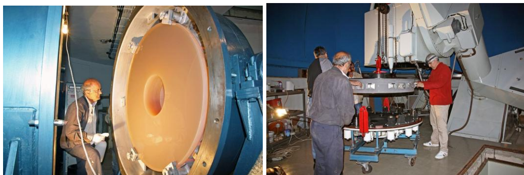
Εικόνα 16. Εικόνες του κατόπτρου 1.2 μ του τηλεσκοπίου του Αστρονομικού σταθμού Κρουονερίου κατά την διαδικασία της επαλουμίνωσης.
