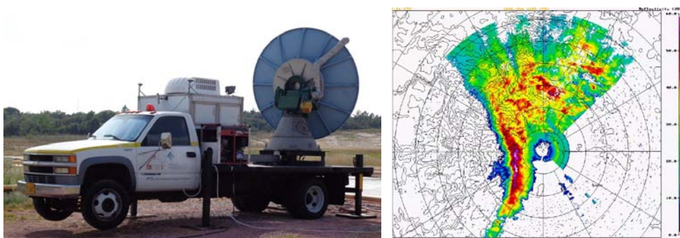
Εικόνα 4.2.6. Μετρήσεις του μετεωρολογικού ραντάρ του ΕΑΑ κατά τη διάρκεια της πειραματικής περιόδου 2013 του προγράμματος HyMeX στην περιοχή Gard της Γαλλίας.
