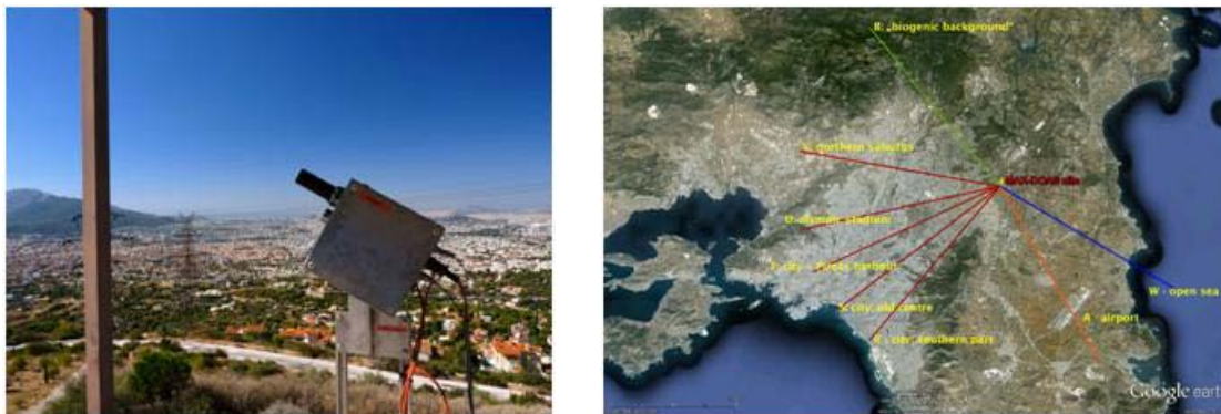
Εικόνα 4.2.2. (α) Το σύστημα Max-DOAS που εγκαταστάθηκε στις εγκαταστάσεις του ΕΑΑ στην Πεντέλη, (β) οι κύριες αζιμουθιακές διευθύνσεις με διαφορετικά χαρακτηριστικά ρύπανσης.
