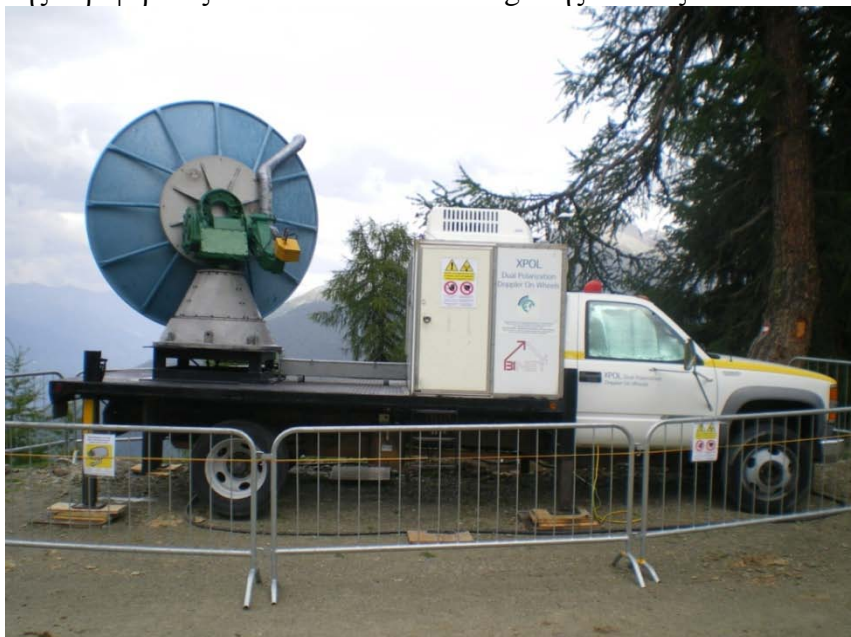
Εικόνα 4.2.5. Το μετεωρολογικό ραντάρ του ΕΑΑ κατά τη διάρκεια μετρήσεων καταγίδων στις Ιταλικές Άλπεις το 2012.
