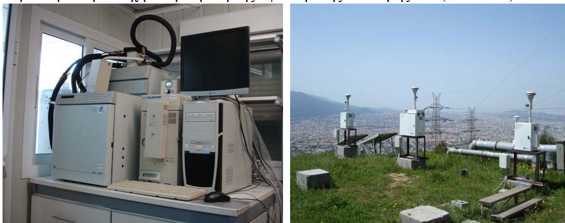
Εικόνα 3.2.1. (α) Αέριος χρωματογράφος με ανιχνευτή ιονισμού φλόγας, (β) Δειγματολήπτες αιωρούμενων σωματιδίων ΑΣ 10 και ΑΣ 2.5 στην Πεντέλη.
