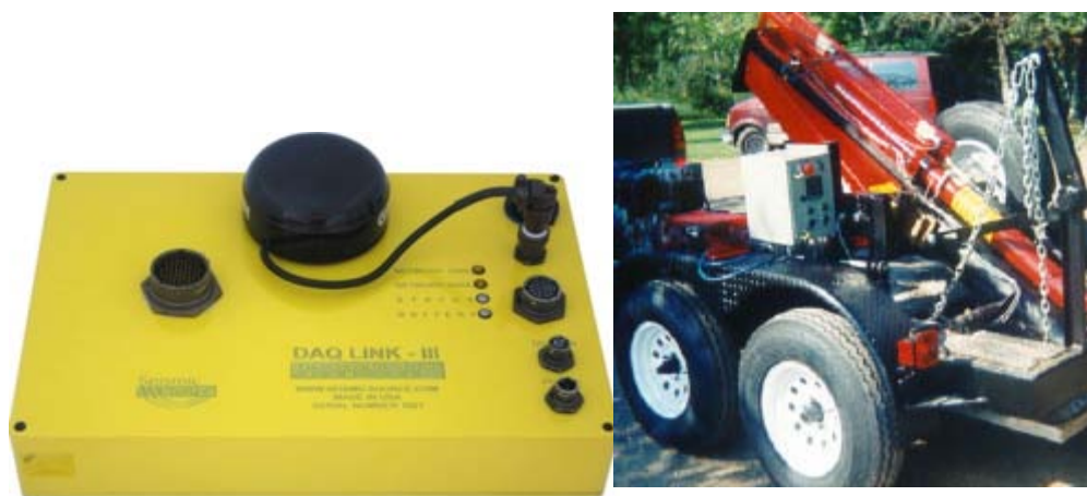
Εικόνα 14. Πολυκαναλικός Σειсмоγράφος και η πηγή του επιταχυνόμενου πίπτοντος βάρους.
